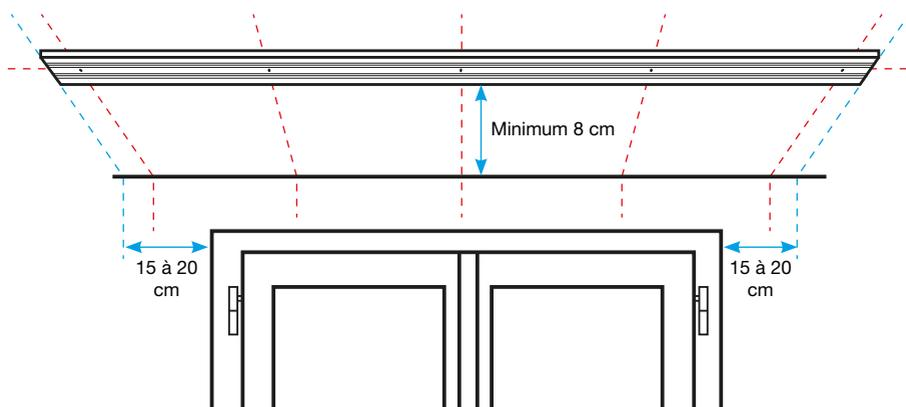
**ETAPE 2 :** Présenter le rail plat, puis marquer la position des perçages (trous). Placer le rail plat au niveau des repères et vérifier que la pose soit parallèle à la fenêtre. Percer et insérer des chevilles adaptées à la nature du plafond. Utiliser des **vis de  $\varnothing 5\text{mm}$  (vis non fournies)** pour la fixation du rail plat.
