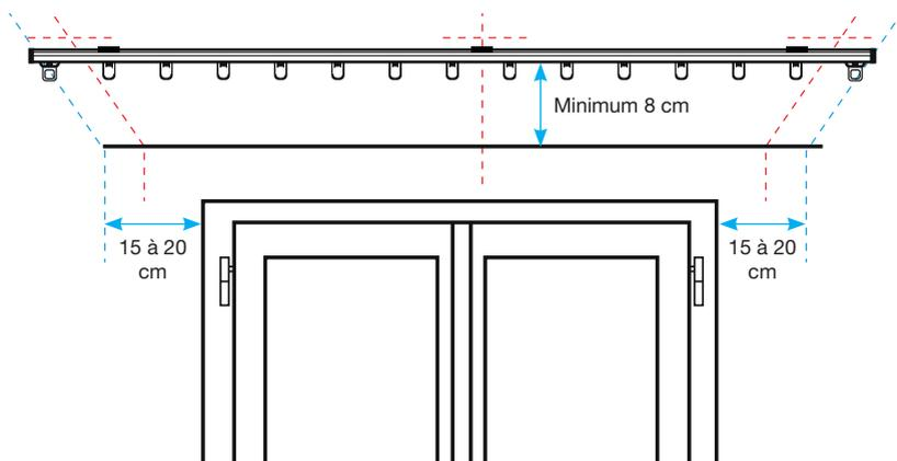
**ETAPE 3 :** Positionner le support du rail 200 sur le repère, puis marquer la position des perçages. Placer le rail 200 au niveau des repères et vérifier que la pose soit parallèle à la fenêtre. Percer et insérer des chevilles adaptées à la nature du plafond. Utiliser des **vis de Ø4 mm** pour la fixation des supports (**vis de poses non fournies**).
