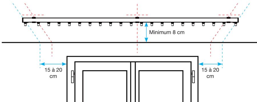
**ETAPE 3 :** Présenter le support avec le rail 100, puis marquer la position des perçages. Placer le rail 100 au niveau des repères et vérifier que la pose soit parallèle à la fenêtre. Percer et insérer des chevilles adaptées à la nature du plafond. Utiliser des **vis de  $\varnothing 5$  mm** pour la fixation des supports.
