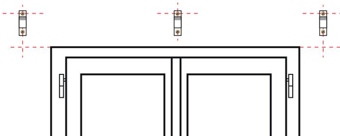
**ETAPE 3 :** Débloquer les machoirs (griffes) des supports muraux (dévisser la vis sans l'enlever - tournevis cruciforme) et clipser le rail 100 sur les supports accrochés au mur. Ajuster et resserrer les vis des machoirs afin de bloquer le rail.
