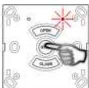
Maintenez la télécommande à max 0,5 mètre distance de la récepteur, choisissez le canal et appuyez le bouton Ouvrir
