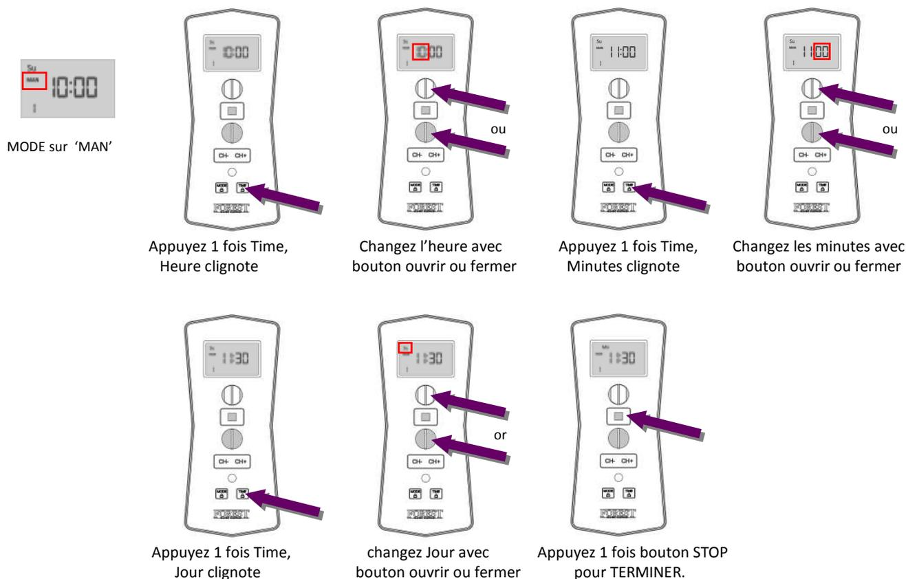
**Réglage automatique de l'heure et du jour** (débloquer la télécommande si nécessaire: Maintenez les deux boutons Mode et Time enfoncés pendant 4 secondes, jusqu'à réapparition de LOC sur l'écran):
