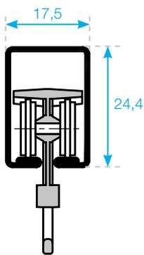
Connu sous sa section 24x16, le rail 100, inventé en 1924 par la Société Boulet, reste un produit référent en terme de qualité et de fiabilité.
